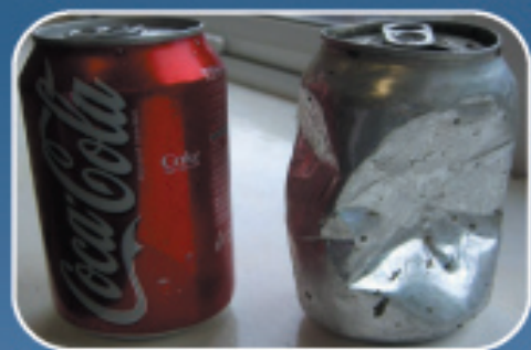
Lattine in alluminio (prima e dopo il trattamento)
